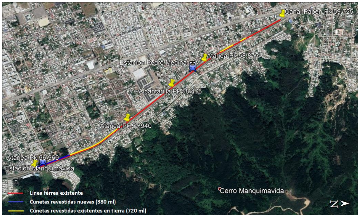
Figura N°2: Emplazamiento de las cunetas a construir
